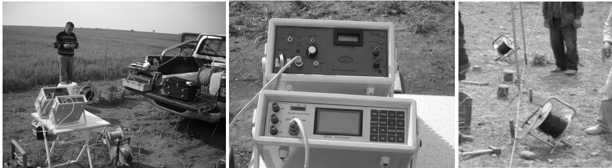
Şekil-3 DSİ Yapımı Rezistivite cihazı ve Araziye elektrotların dizilimi
